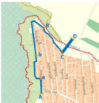
Figur 2-1 Placering og tracé for det planlagte kystbeskyttelsesanlæg. Fjorddiget, der ligger til grund for Natura 2000-vurderingen, udgøres af strækning AB. Strækningen af etableres som fast spuns. Natura 2000-området er vist ved skravering (Roskilde Kommune 2014).
