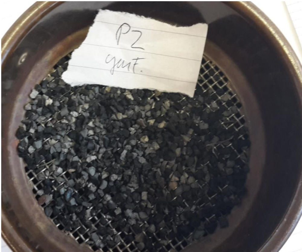
Figur 6 Prøve 2 >2 mm, fra kunstgræsplæne. Prøven består af to typer gummigranulat.
