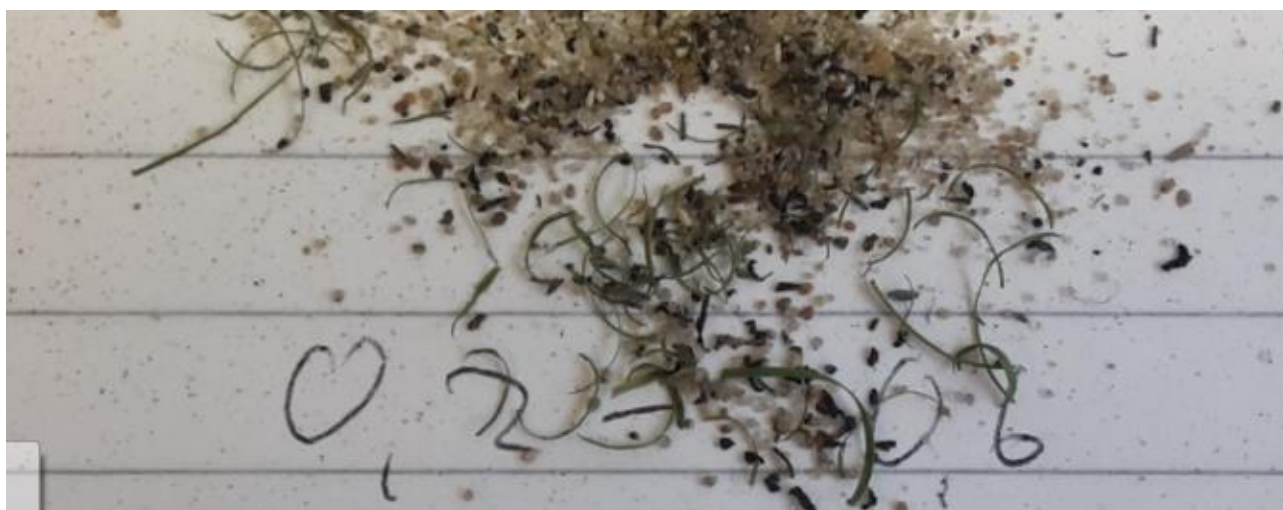
Figur 5 P2, 0,2 til 0,6 mm. viser både mindre gummifragmenter, grønne spikler fra plæne og finsand/ silt.
