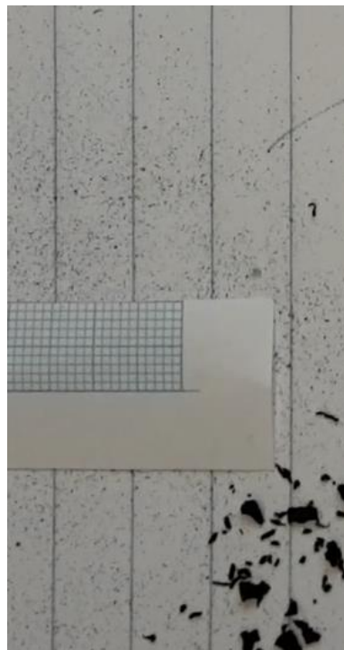
Figur 4 Venstre < end 0,2 mm. Højre samme prøve men med den større fraktion. Den fine fraktion virker lidt "klæbende" og hænger ved fingrene. De angulære fragmenter i størrelsen <0,6 ses til højre.
